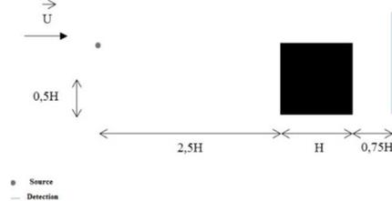
**Figure 2.** Disposição da fonte e dos detectores do experimento Mavroidis et al., (1999).
